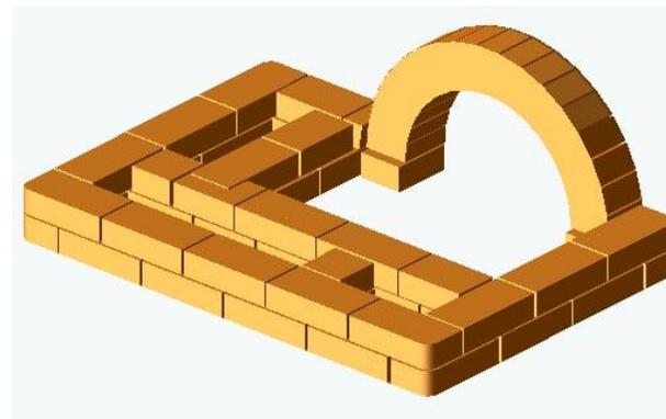
Арка. На кирпичи 14 ряда устанавливается полуарка, выложенная из 17 кирпичей. Радиус кружала, по которому выкладывается арка, составляет 259 мм. Для арки используются заготовки кирпичей размером 120x142 мм, сточенные на конус. Нижняя часть конусного кирпича составляет примерно 44-45 мм. Количество кирпичей – 17 (красный).
