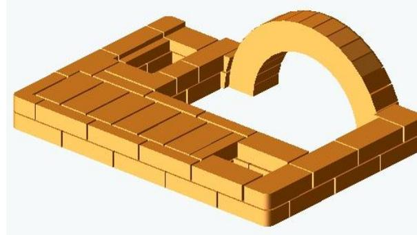
16 ряд. Выполняется перекрытие нижнего колпака печи. Канал «летнего» уменьшается до размера в один кирпич. В кирпичах, образующих данный канал, делаются вырезы для установки задвижки «летнего» хода. Кирпичи, прилегающие к арке, подрезаются снизу наискосок по конфигурации арки. Количество кирпичей – 22 и ½ (красный).
