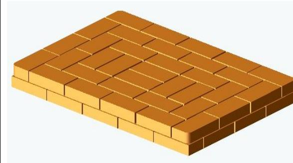
2 ряд. Так же сплошной. Кладется по схеме. Предполагается, что данный ряд будет находиться на уровне чистового пола. Угловые кирпичи ряда имеют дополнительную обработку в виде скругленных углов. Делать такую обработку для этого и последующих рядов необязательно. Количество кирпичей – 35 (красный).
