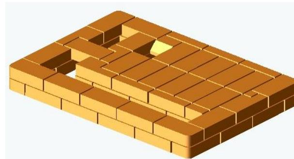
21 ряд. По уложенным уголкам перекрывается варочная камера печи. Оставляется выход для вытяжки из варочной камеры. Половинка кирпича, прилегающая в передней части к вытяжному каналу срезается сверху наискосок. Формируется основной дымоход печи, над которым будет устанавливаться труба. Количество кирпичей – 30 и ½ (красный).
